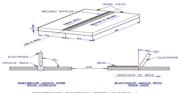
ELECTRODE POSITION WHEN MAKING A BUTT JOINT IN A FLAT POSITION
